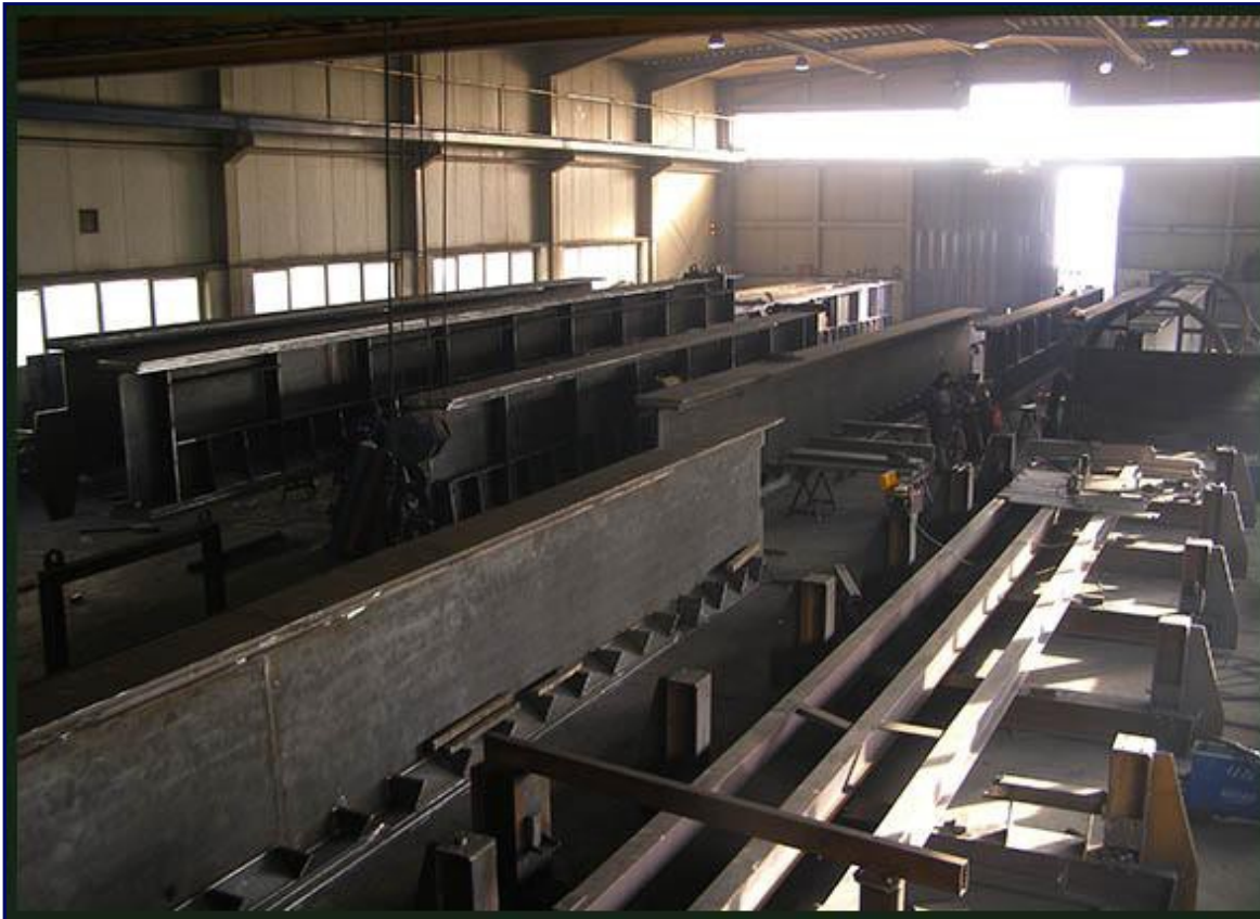
Berlin Ostkreuz Hauptträger der Gleisbrücken
